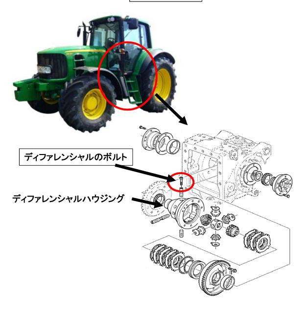
後軸のディファレンシャル(差動装置)のボルトが、ジョンディア社の生産工場で適切に締結されていないため、走行中に緩む場合がある。このため、そのままの状態で使用を続けると、最悪の場合ボルトが脱落しディファレンシャル内のギアが嚙みこみデファレンシャルハウジングが破損することによって走行ができなくなるおそれがある。
