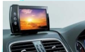
カーナビ ジャイロ、地磁気センサ 絶対圧センサ
