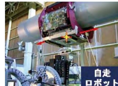
日立エンジニアリングアンドサービスが開発したプラント配管自走ロボット
