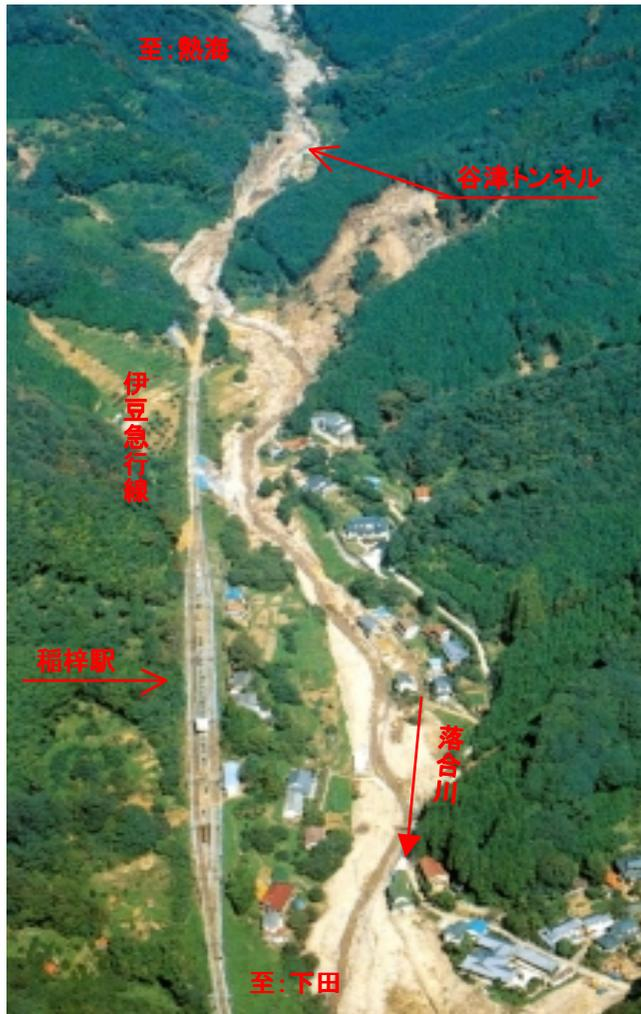
土砂と水に埋没した谷津トンネル
