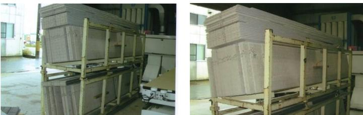
加工場で加工（プレカット）したサイディングを、施工現場まで傷つけずに運搬することと、施工時に施工順に取り出しやすいことを念頭に試作した。加工場での積み込みと、現場での取り出しにさらに工夫をし、運搬時損数（上記表⑤参照）を0にできるよう検討する。
