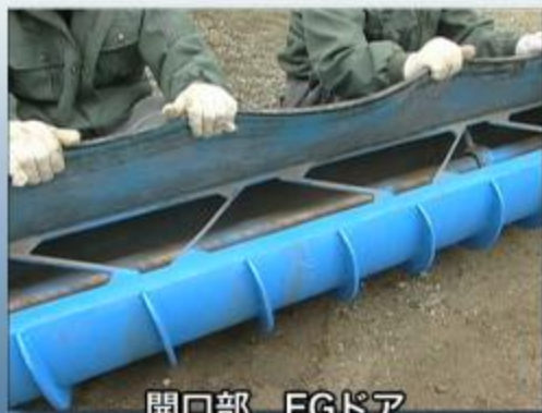
ケーシング側面の碎石投入口とゴム扉
