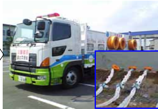
高揚程排水ポンプ車の配備 (ポンプ2基直列による高揚程化)
