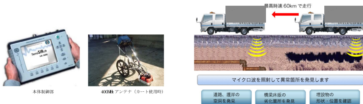
図-2 地中レーダー探査のイメージ
