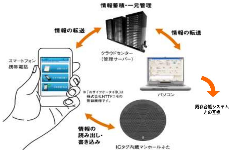
図 5-3 2 IC タグの概要
