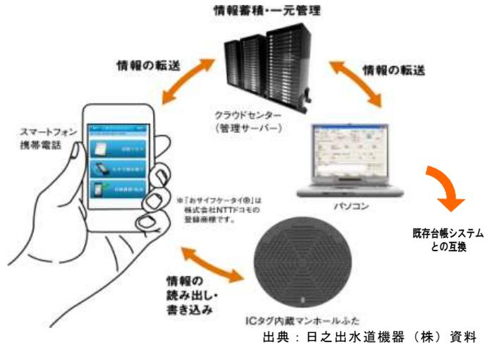
図 4-2 3 モバイル機器を用いた管渠データ現地入力の事例
