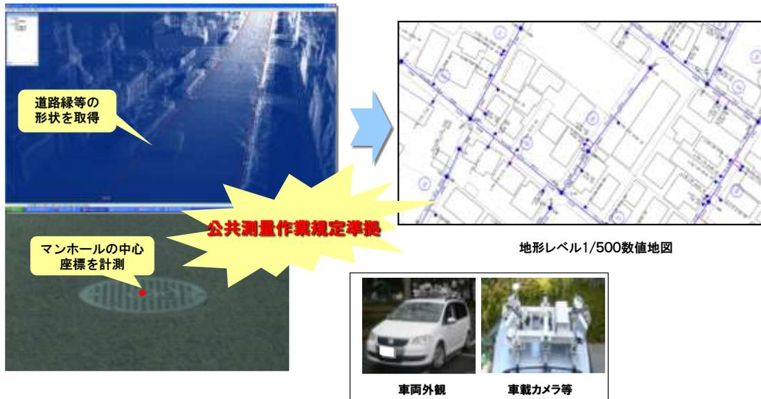
図 5-2 1 MMS による管渠台帳作成の概要
