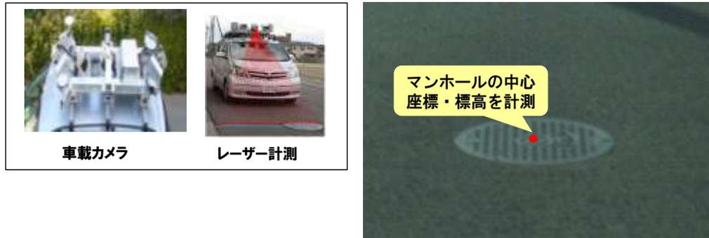
図5-23 MMSによるマンホール調査の概要
