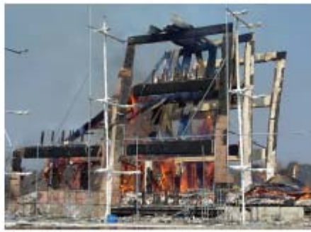
94分：枠組部分倒壊
