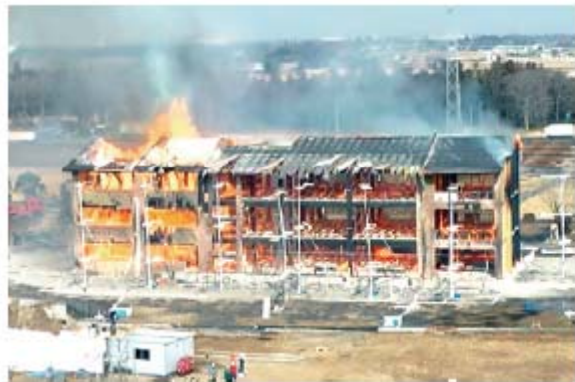
94分：枠組部分倒壊
