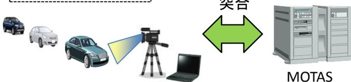
ナンバー自動読取装置・カメラを街頭検査の際等に設置し、読み取ったナンバーとMOTASの情報を突合し、無車検車・無保険車を捕捉
