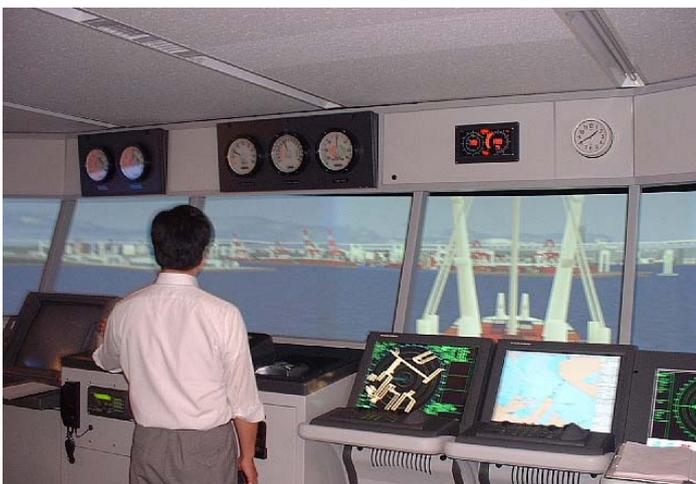
船舶交通流シミュレーションで使用した収集データを、操船シミュレータ装置にビジュアル的に再現し、必要な諸条件を設定の上、被験者(船長)により同装置を操船させるシミュレーションを実施。
