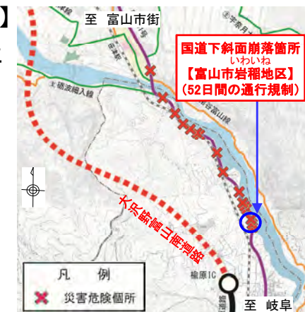
図4 国道41号の災害危険箇所（災害危険箇所：H24防災点検の結果、対策が必要とされた箇所及び防災力向上に対応する箇所）
