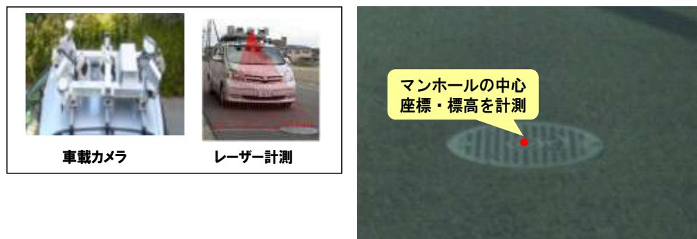
図 5-2-3 MMSによるマンホール調査の概要
