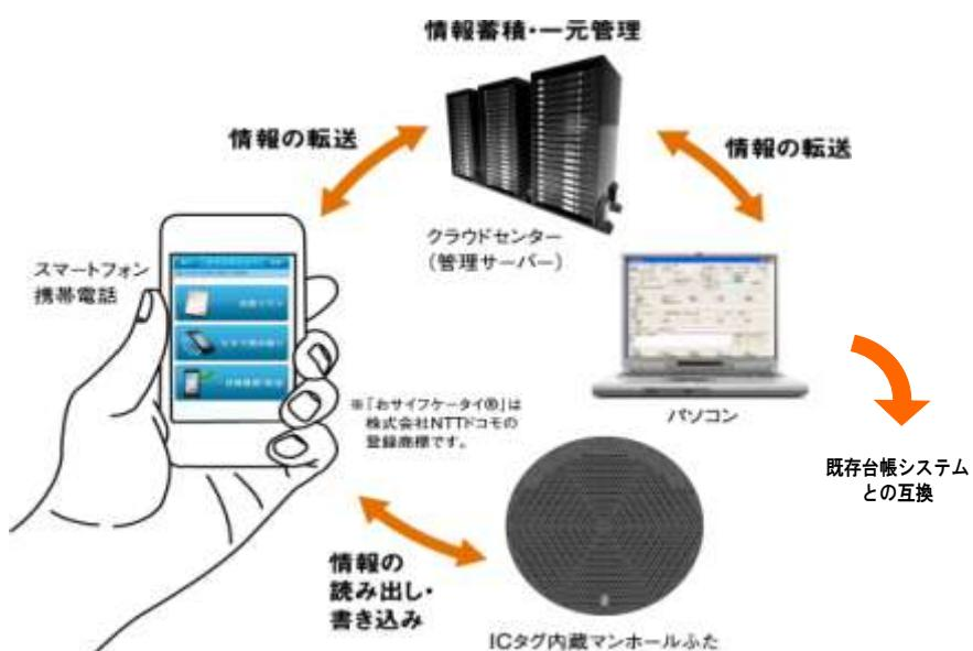
図5-3-2 IC タグの概要
