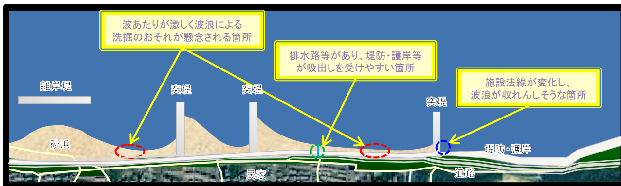
【地形等により劣化や被災による変状が起こりやすい箇所のイメージ】
