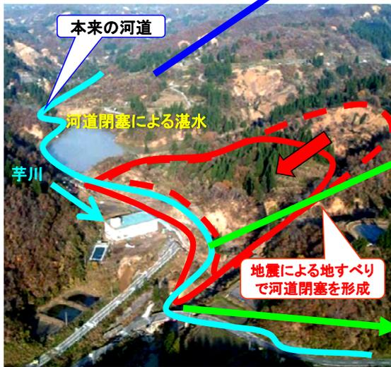
新潟県中越地震により発生した地すべりによる河道閉塞形成状況
