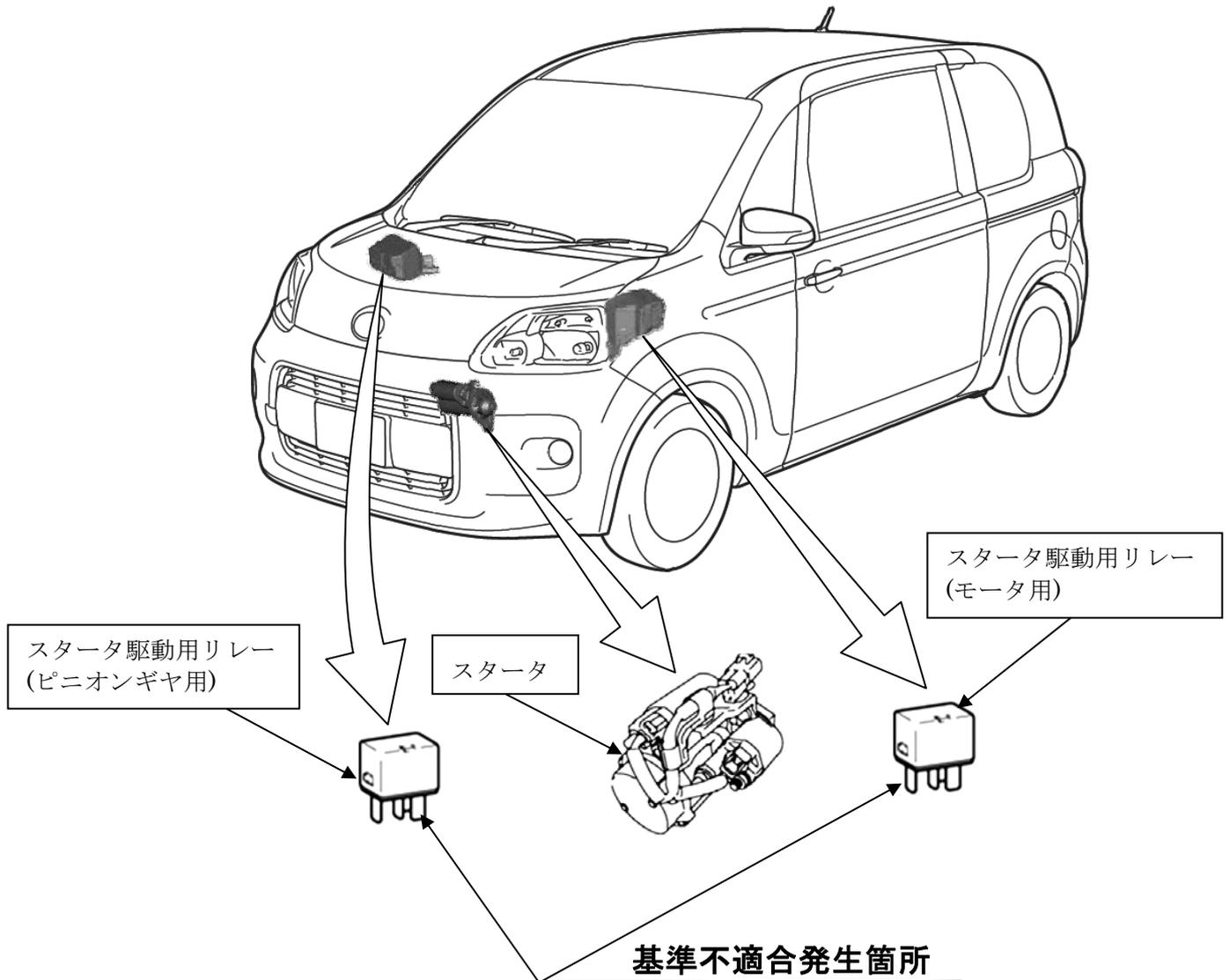
始動装置のスタータにおいて、スタータ駆動用リレーの通電設定が不適切なため、接点部に銀成分が凝集するものがある。そのため、そのままの状態で使用を続けると、接点部から銀成分がはがれ落ち、回路内に挟まると当該リレーが通電状態となりスタータが回転し続け、最悪の場合、火災に至るおそれがある。
