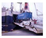
ROLL-ON/ROLL-OFF船の略。 貨物をトラック、トレーラに積載した ままでの岸壁から船舶への積み込 み 又は、船舶から岸壁への取り 卸し荷役が可能な船舶
