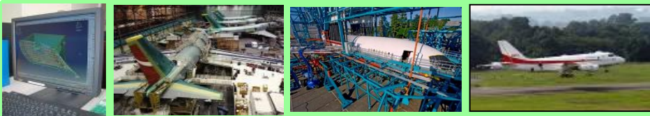
図面審査 製造過程の検査 全機静強度試験 飛行試験
