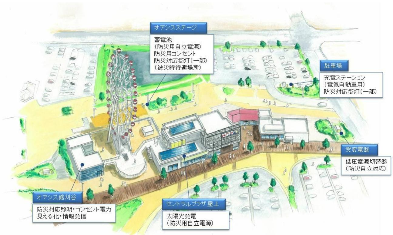
図3．防災型電力システムイメージパース
