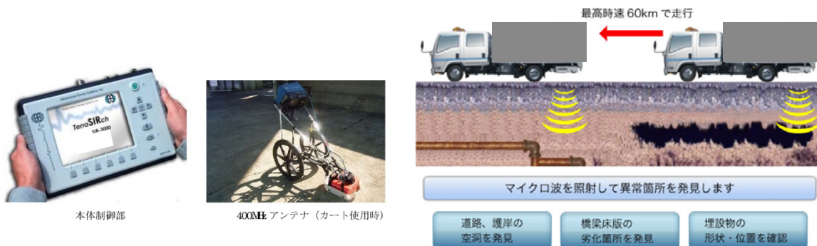
図-2 地中レーダー探査のイメージ
