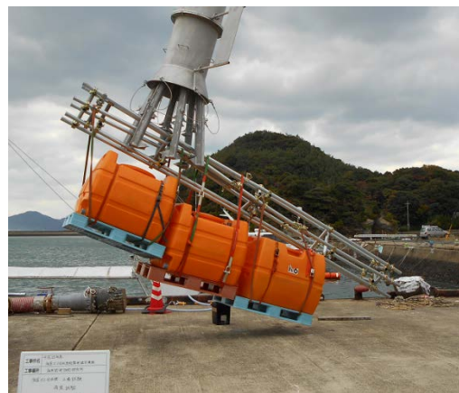
写真-1.1.1.3 陸上実験 (1ton荷重試験)
