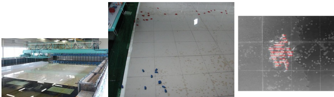
図-1.1.1.24 実験水槽（左）、ガレキ実験の様子（中）およびビデオ画像解析結果の一例（右）
