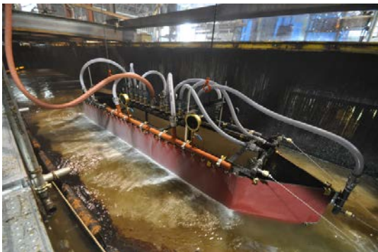
写真-1.1.1.1 油回収船模型の防汚総合試験
