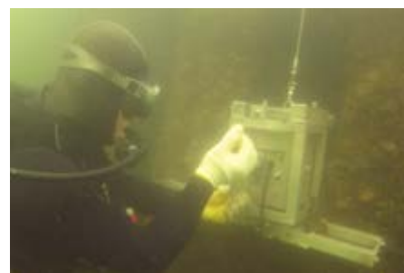
写真-1.1.1.6 潜水士による肉厚測定（現地試験）
