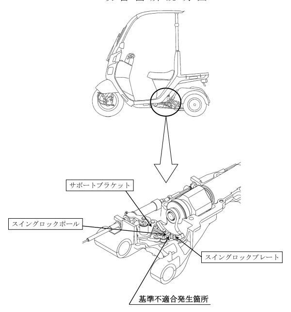
駐車ブレーキ作動時に車体の直立を保持するスイングロック機構において、サポートブラケットの加工が不適切なため、スイングロックポールとスイングロックプレートの爪部の噛み合いが浅くなるものがある。そのため、スイングロックプレートの爪部に力が掛かる状態で駐車ブレーキを解除する操作等を繰返すと、スイングロックプレートの爪部が早期に磨耗し、そのままの状態で使用を続けると、最悪の場合、駐車ブレーキを作動させても車体が傾くおそれがある。
