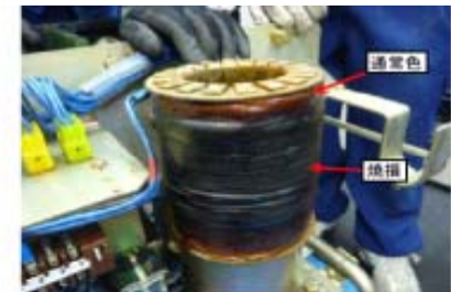
励磁コイル焼損(拡大)
