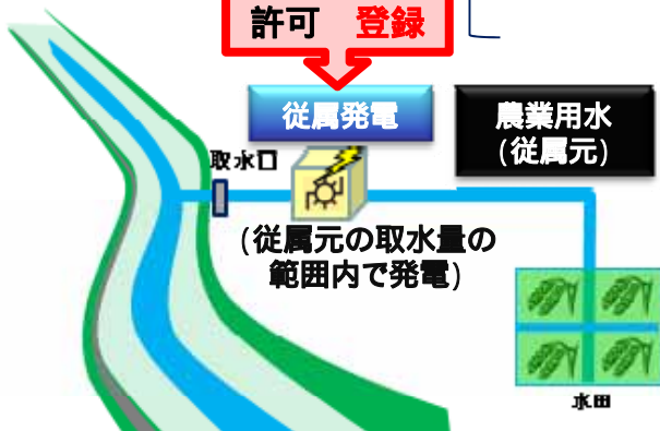
< 農業用水を利用した小水力発電の例 >
