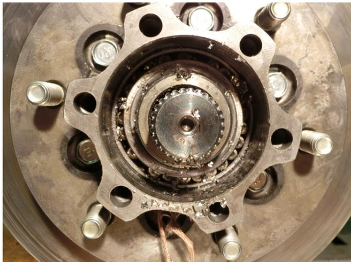
図3 ベアリングの焼き付き、損傷状態
