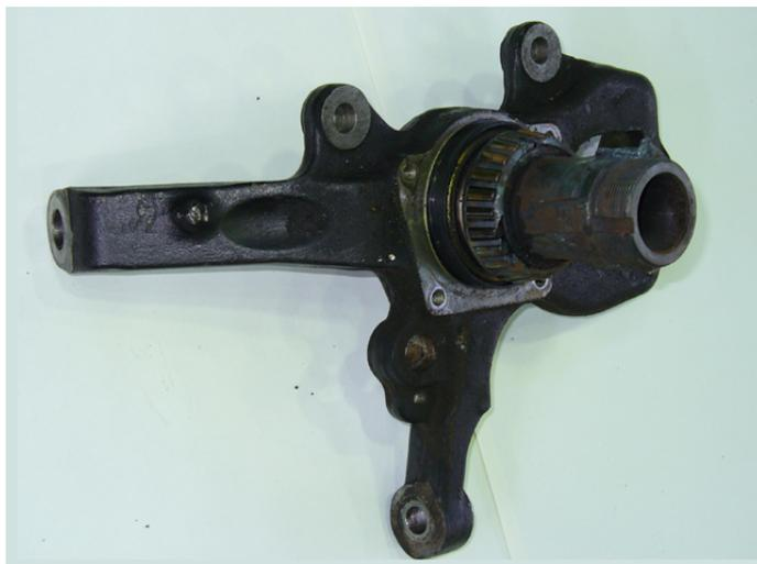
図4 焼き付きによる車輪ロック時の衝撃により曲がった車軸
