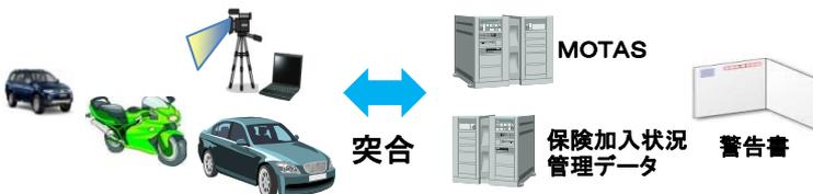
ナンバー自動読取装置・カメラを路上に設置し、読み取ったナンバーをMOTAS情報や保険加入状況管理データと突合し、無車検車・無保険車を捕捉
