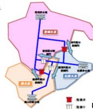
今回の事例では、県水系統が供給停止したことから、別系統(松原水系)より、連絡管を通じて水を融通
