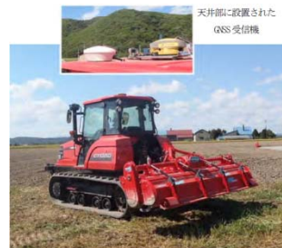
GNSS受信機を搭載したトラクタ
