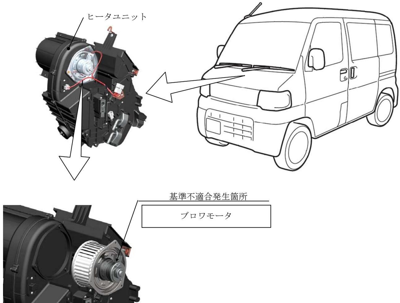
ブロワモータのブラシの材質が不適切なため、最大風量での長時間使用を繰り返すと、ブラシが早期に摩耗する可能性がある。そのため、ブロワモータの回転が遅くなり、そのまま使用を続けると作動が停止し、前面ガラスに曇りが生じた場合に安全な視野を確保できなくなるおそれがある。
