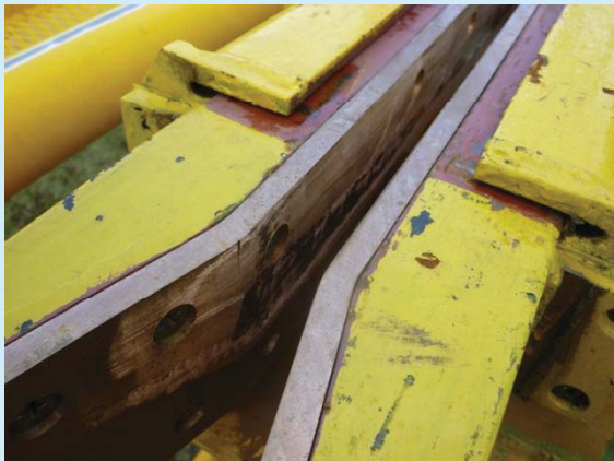
ブレーキのライニングに摩耗粉が付着
