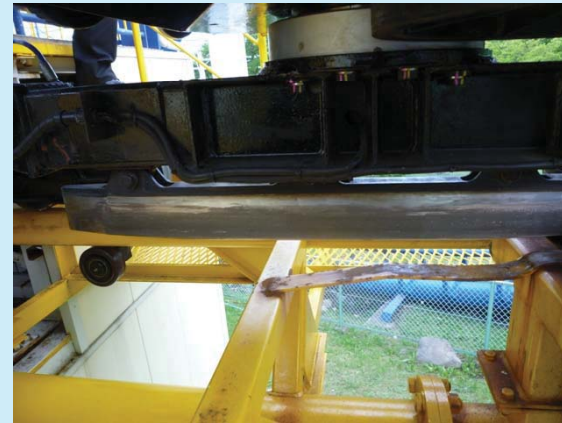
コースター下部のフィンに摩耗粉が付着
