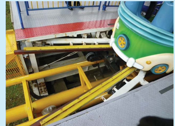
衝突した回転止め装置(姿勢制御装置)
