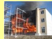
防火壁による延焼防止性能の検証
