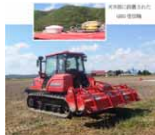
GNSS受信機を搭載したトラクタ
