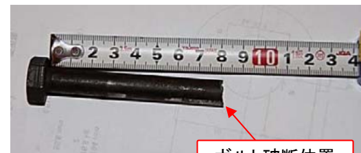
ボルト破断位置
