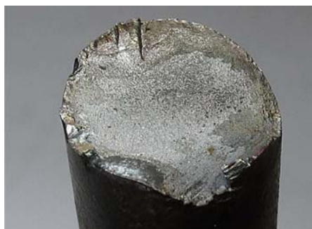
写真3. ボルト破断面
