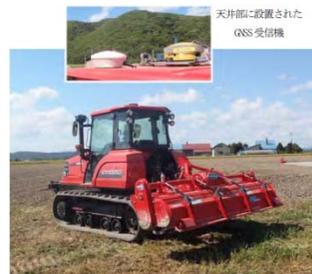
GNSS受信機を搭載したトラクタ
