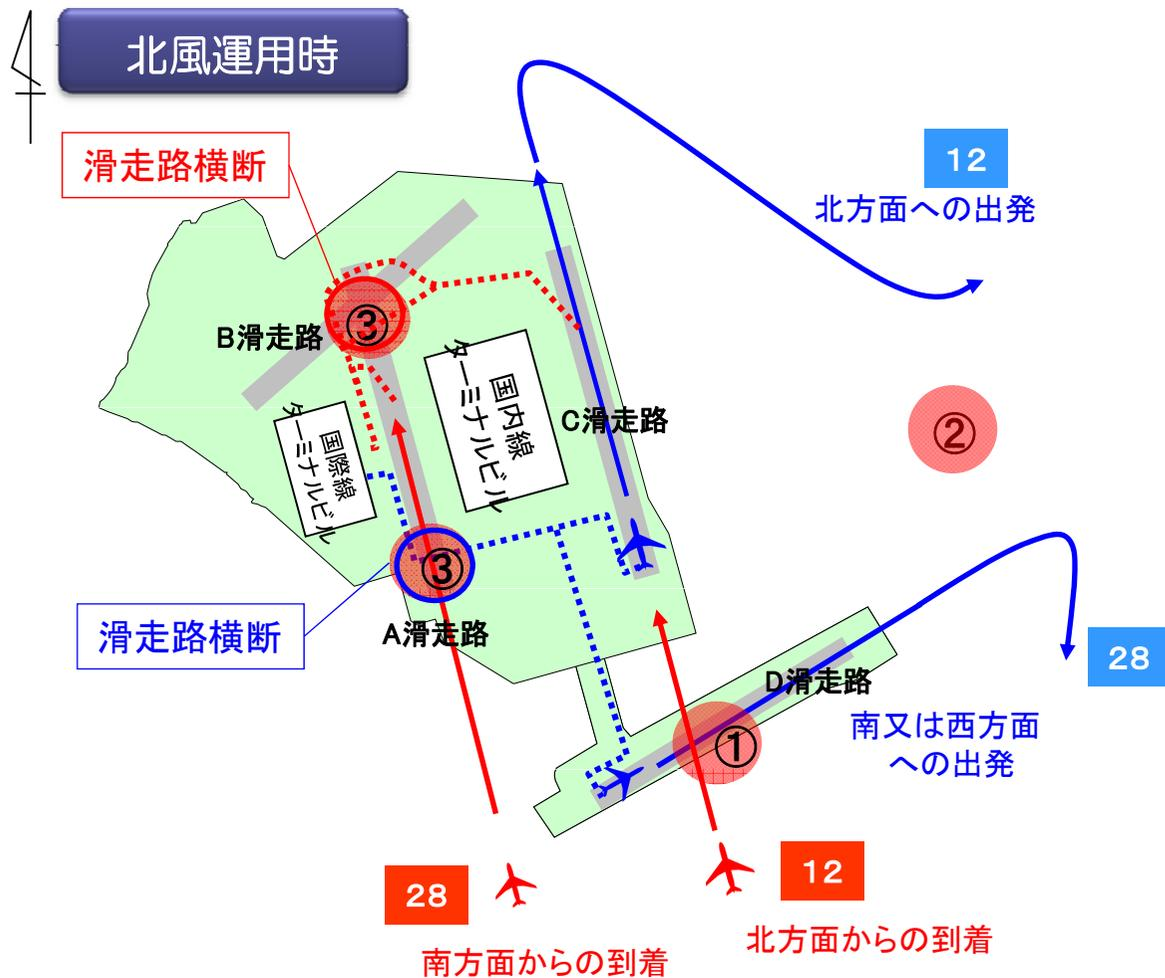
○現在の北風運用時の滑走路使用の組み合わせは、航空機が交差する地点の数が少ないため、もっとも効率的に運用されており、現在のパターンのもまでも、離陸後の飛行経路の問題(左図②)が解決できれば最大の発着回数を確保することができる。
