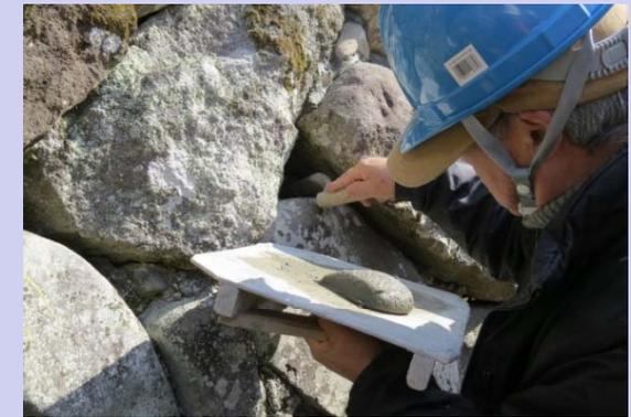
1/7サイズの石製模型を活用した実験を通じて石橋の構造を明らかにし、石橋の点検・修理手法等を実用的なマニュアルとして整理【大分県宇佐市】
