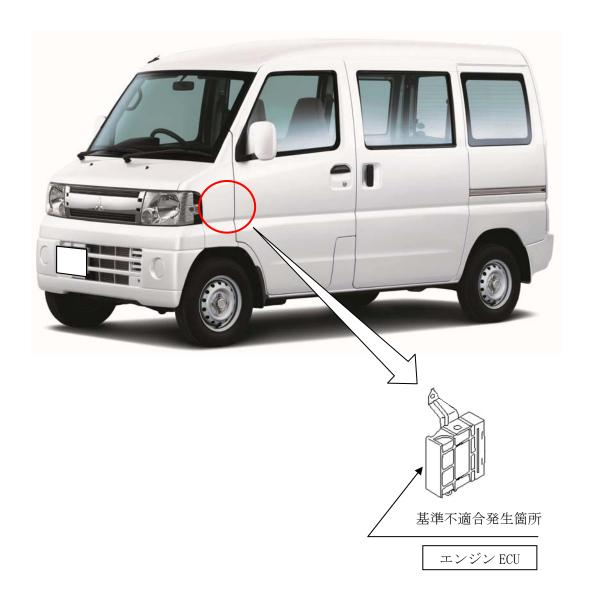
エンジン ECU の IC 製造工程管理が不適切なため、使用過程での環境温度変化により、IC 内部の配線が断線することがある。そのため、燃料ポンプ制御に異常が生じ、燃料が適正に供給されなくなり、最悪の場合、始動不能または走行中エンストに至るおそれがある。
