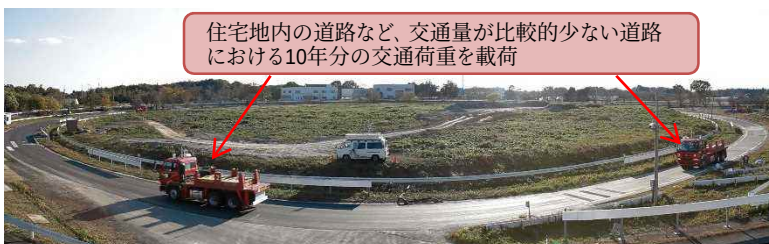
自動走行大型車両による載荷試験
