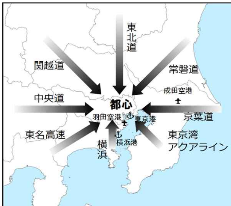
<八方向作戦による道路啓開>
