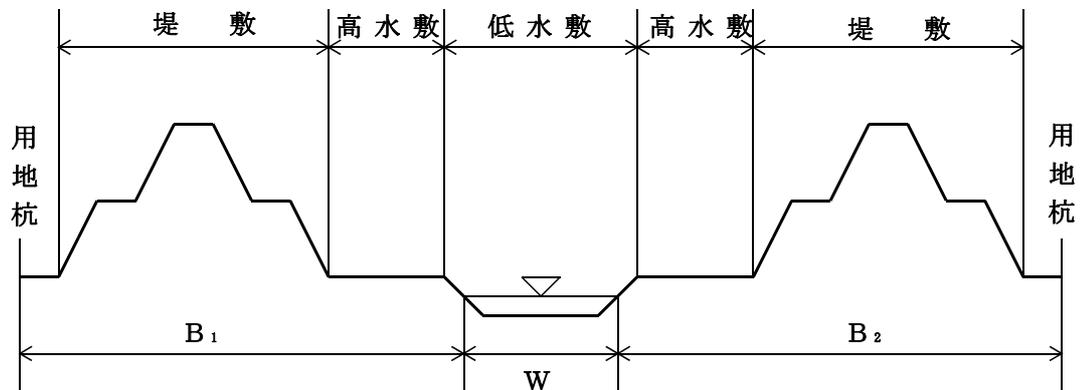
5 - 2 - 2 河川横断（山地）の測量幅は，右図の全幅Bをとる。
