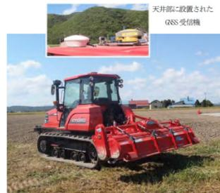
GNSS受信機を搭載したトラクタ
