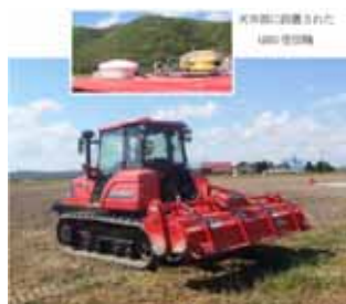
GNSS受信機を搭載したトラクタ
