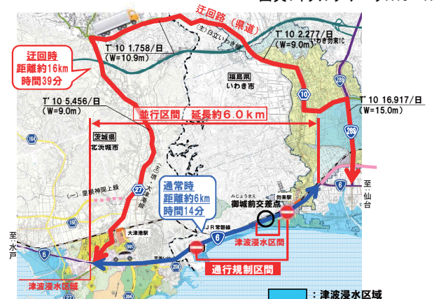
図7 国道6号の津波浸水、迂回路状況
