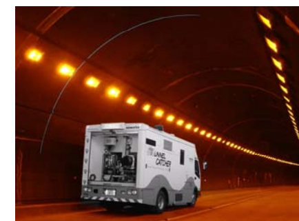
レーザーによる ひび割れの検出
