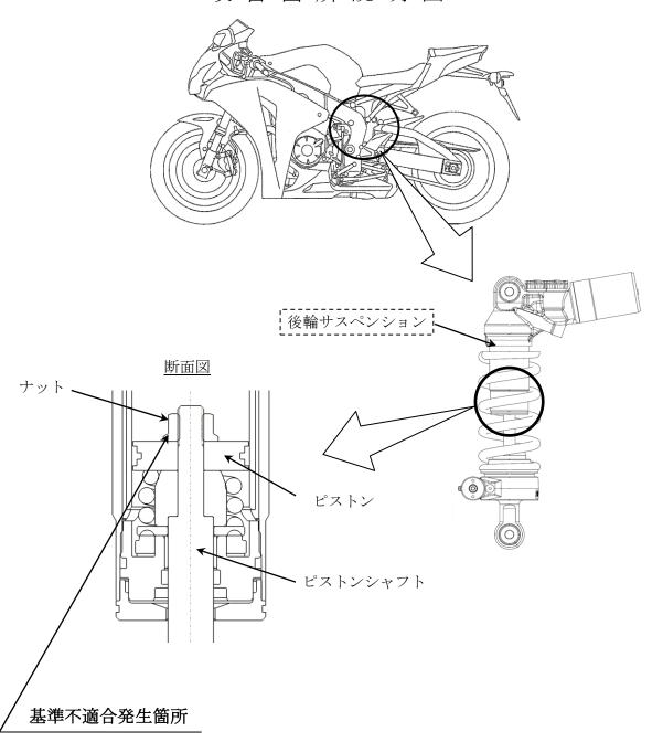
後輪サスペンションにおいて、ピストンとピストンシャフトを締結するナットの締付け工程が不 適切なため、締付け力が不足しているものがある。そのため、そのままの状態で使用を続けると、 当該ナットが外れ、緩衝機能が低下して、走行安定性を損なうおそれがある。
