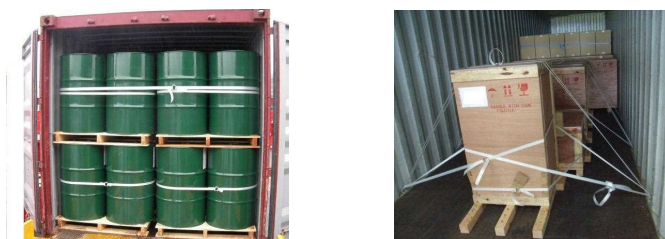
図 30 コードストラップを使用した固定 (例)
