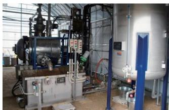
水熱処理装置による下水汚泥や生ごみの可溶化
