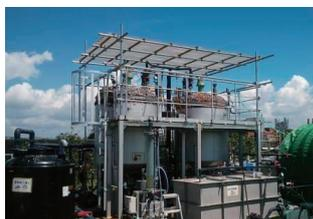
水熱処理を施した下水汚泥と生ごみの混合消化試験
