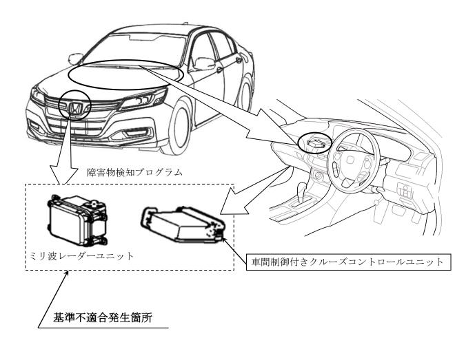
前方障害物衝突軽減制御装置(衝突軽減ブレーキシステム)装着車において、ミリ波レーダーによる障害物検知プログラムが不適切なため、路肩や中央分離帯等に防護柵があり、先行車との車間距離が離れた際に、受信したミリ波情報を稀に前方障害物と誤認識することがある。そのため、衝突の可能性がないのに、マルチインフォメーションディスプレイに警告表示がされるとともに警告音を発し、予期せぬ急制動がかかるおそれがある。
