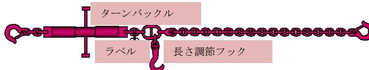
図 7.18 長さ調節フック付きの標準的なチェーンラッシング
