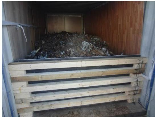
図 7.55 壁の覆いと扉の障壁を取付けた CTU に積載されるスクラップ
