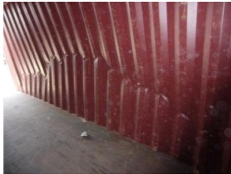
図 7.50 損傷を受けた CTU の側壁
