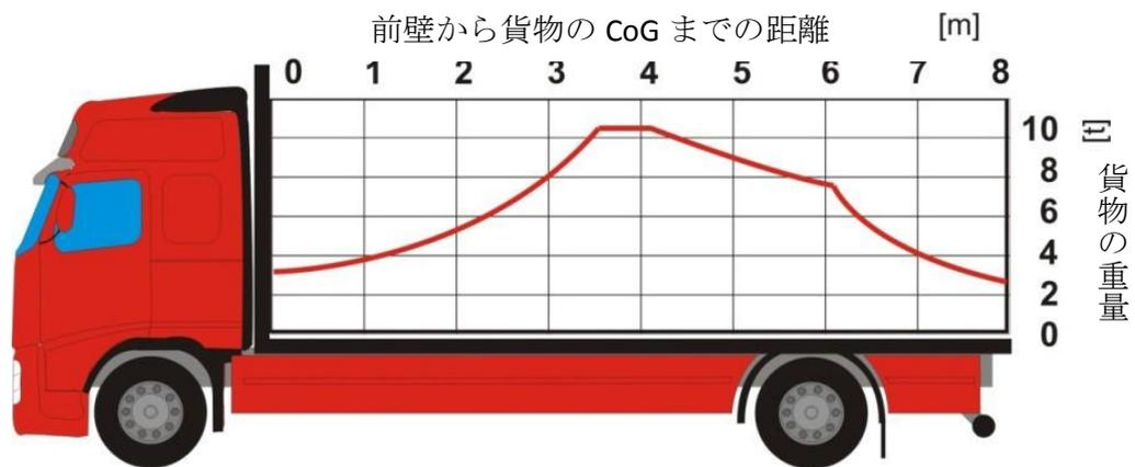
図 7.22 リジッドトラックの荷重分布例のグラフ
