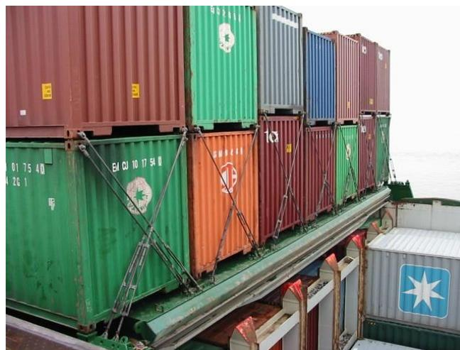
図 2.2 コンテナ船のセルガイドおよびラッシングロッド
