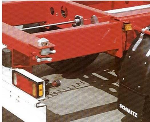
図 2.1 道路車両のツイストロック
