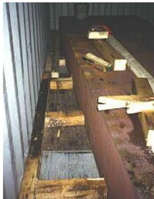
図 7.45 鋼スラブの横方向の根止め材
