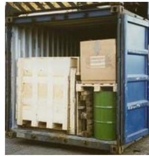
図 7.28 パレットを使用した混合積み込み
