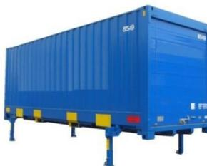
図 5.6 支持脚を使って地面に置かれるスワップボディ
