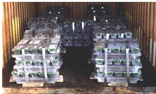
図 7.19 スチールバンドによって結束された金属インゴット（固縛は完了していない状態）
