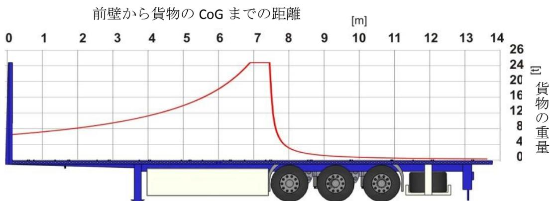
図 7.23 セミトレーラーの荷重分布例のグラフ
