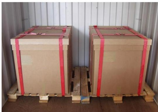
図 7.8 布製ラッシングでパレットにしっかりと固定されている貨物
