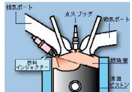
図. 3 直噴ガソリンエンジンの例
