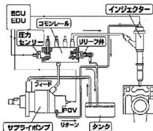
図. 4 コモンレール噴射装置の例
