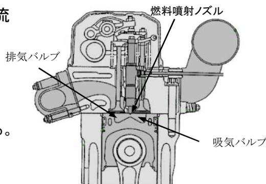
図.1 4バルブセンタノズル化の例
